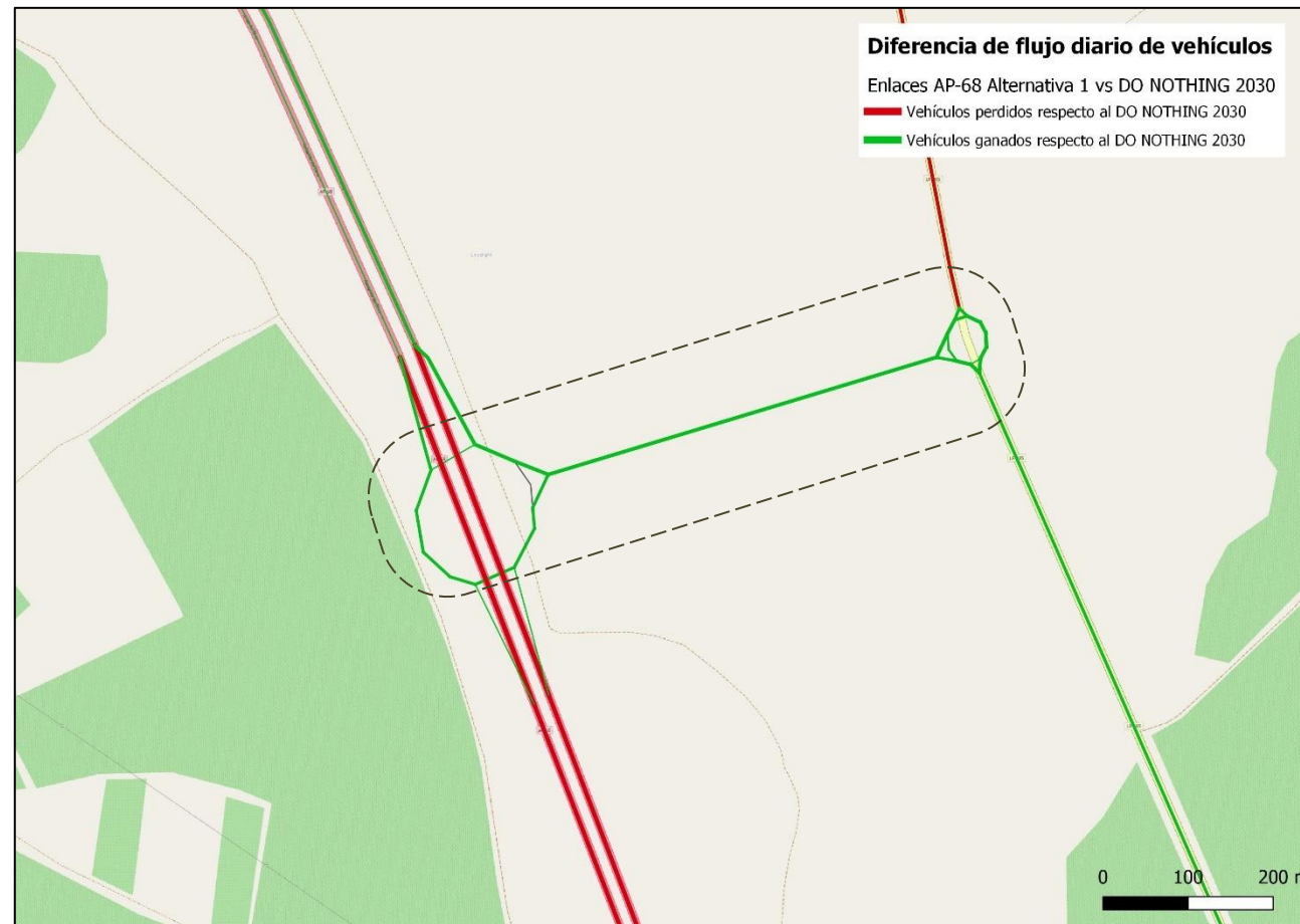
Ilustración 43 - Diferencia de flujo entre el escenario DN 2030 y la Alternativa 2. Enlace con la LR-285.
